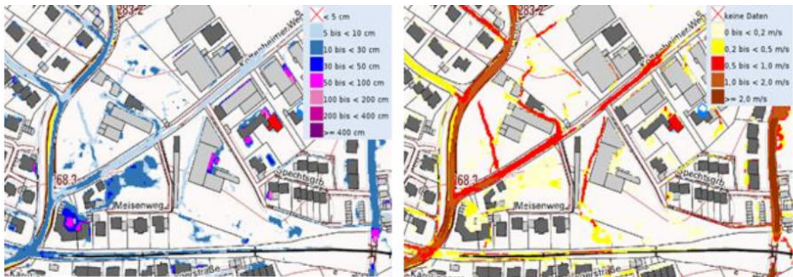
Abbildung links zeigt die Wassertiefen, Abbildung rechts die Fließgeschwindigkeiten beim Starkregenindex 7 (SRI 7 in einer Stunde)
