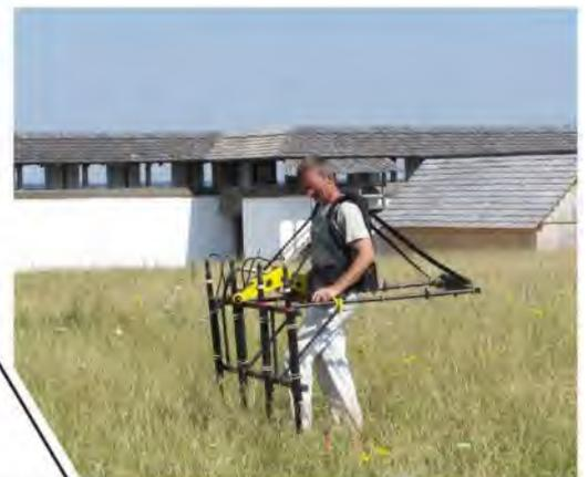
Vier-Kanal-Gradiometer FEREX bei der Messung
