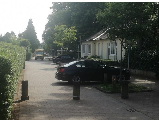
Foto 05: Mittlere Kurhausstr. im Bereich des Kurhäuschens. Die grauen Beton-Poller sind zu ERA-konform zu umzugestalten, d.h. besser sichtbar, mit vorwarnender Linie und in größerem Abstand.
