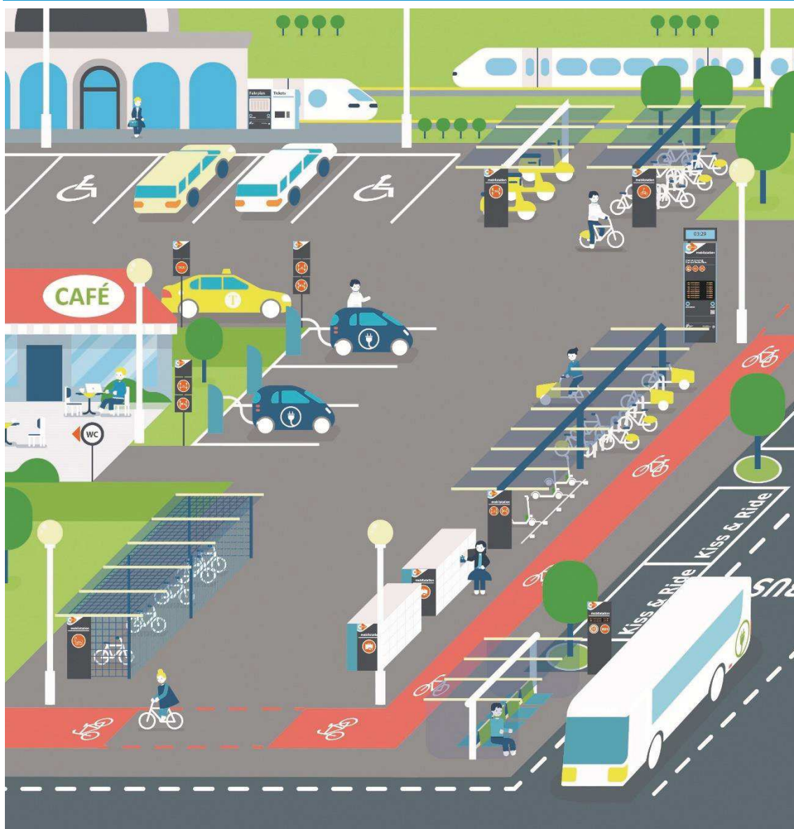
Abbildung 8: Aufbau einer Mobilstation
