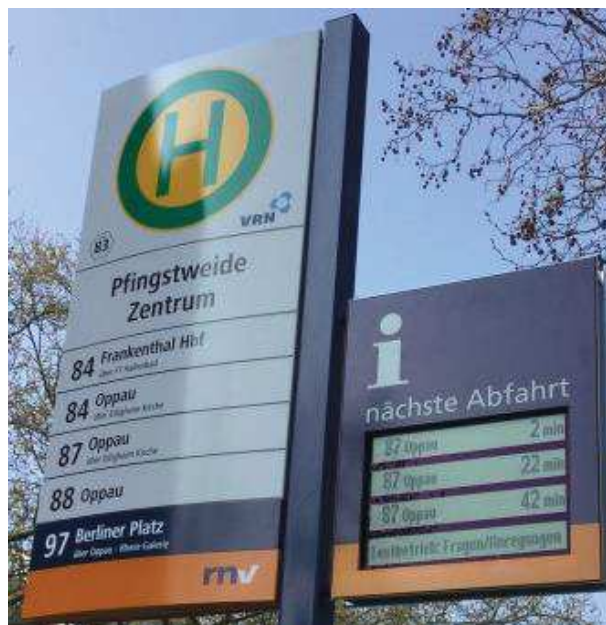
Abbildung 39: Außerhalb des Haltestellenschildes angebrachte DFI Light (Mannheim)
