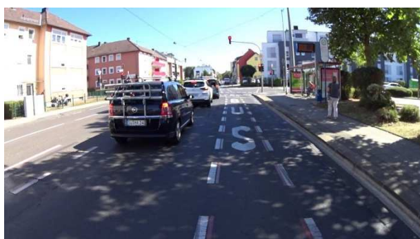
Bild 152: Frankfurter Straße (B 8) – Schutzstreifenmarkierung im Bereich einer Bushaltestelle
