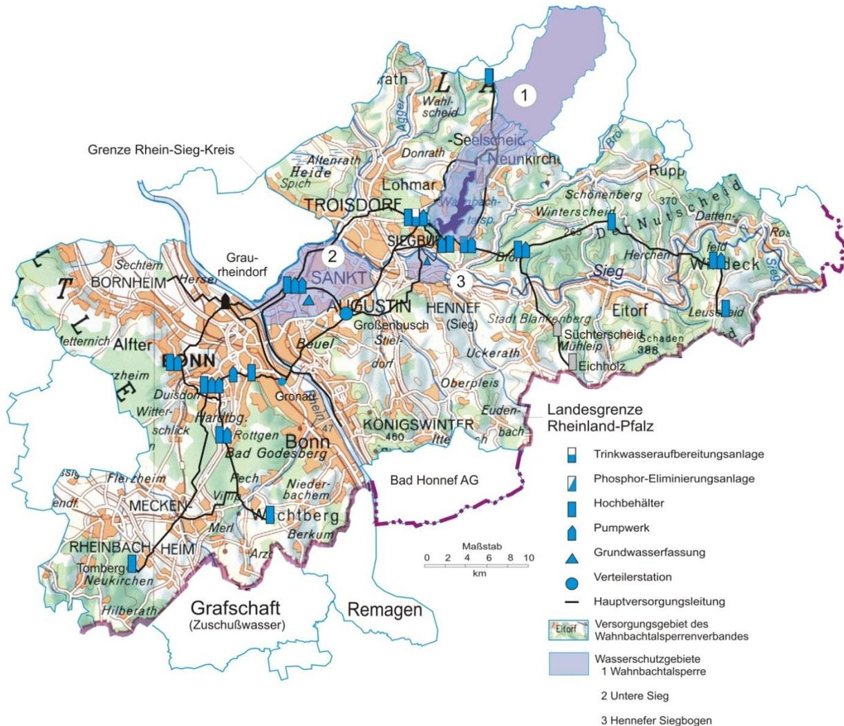
Abbildung 9: Übersichtsplan – Wassergewinnungsanlagen/-gebiete (Wasserschutzgebiete) des Wahnbachtalsperrenverbandes (Quelle WTV)
