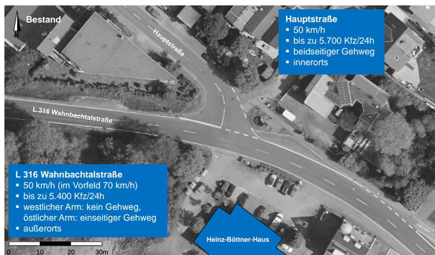
Bild 25: Knotenpunkt L 316 Wahnbachtalstraße/ Hauptstraße – Zusammenstellung der Fakten zur Verkehrssituation im Bestand
