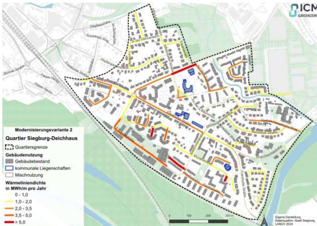
Abbildung 70: Darstellung der Wärmeliniedichte nach Umsetzung von Modernisierungsvariante 2
