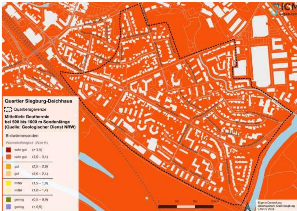
Abbildung 80: Mitteltiefe Geothermiepotenziale bei einer Sondenlänge von 500 bis 1.000 Meter in W/mK
