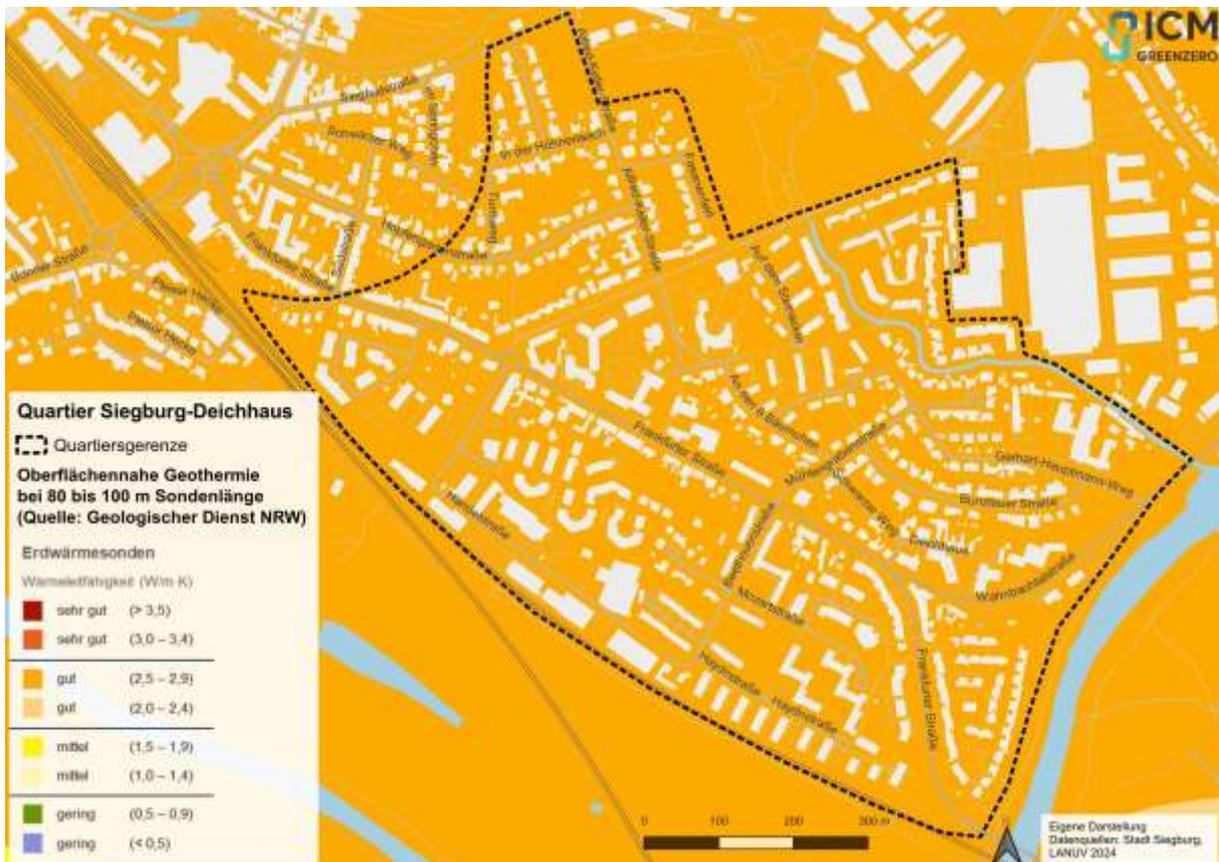
Abbildung 78: Geothermiepotenziale bei einer Sondenlänge von 80 bis 100 Meter in W/mK
