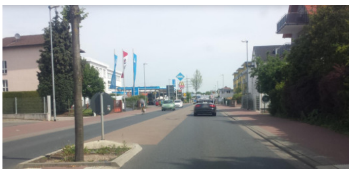
Beispiel 2: Multifunktionsstreifen (Abbiegestreifen, Querungshilfe) mit verkehrsberuhigenden Elementen auf der Friedberger Straße in Bad Vilbel
