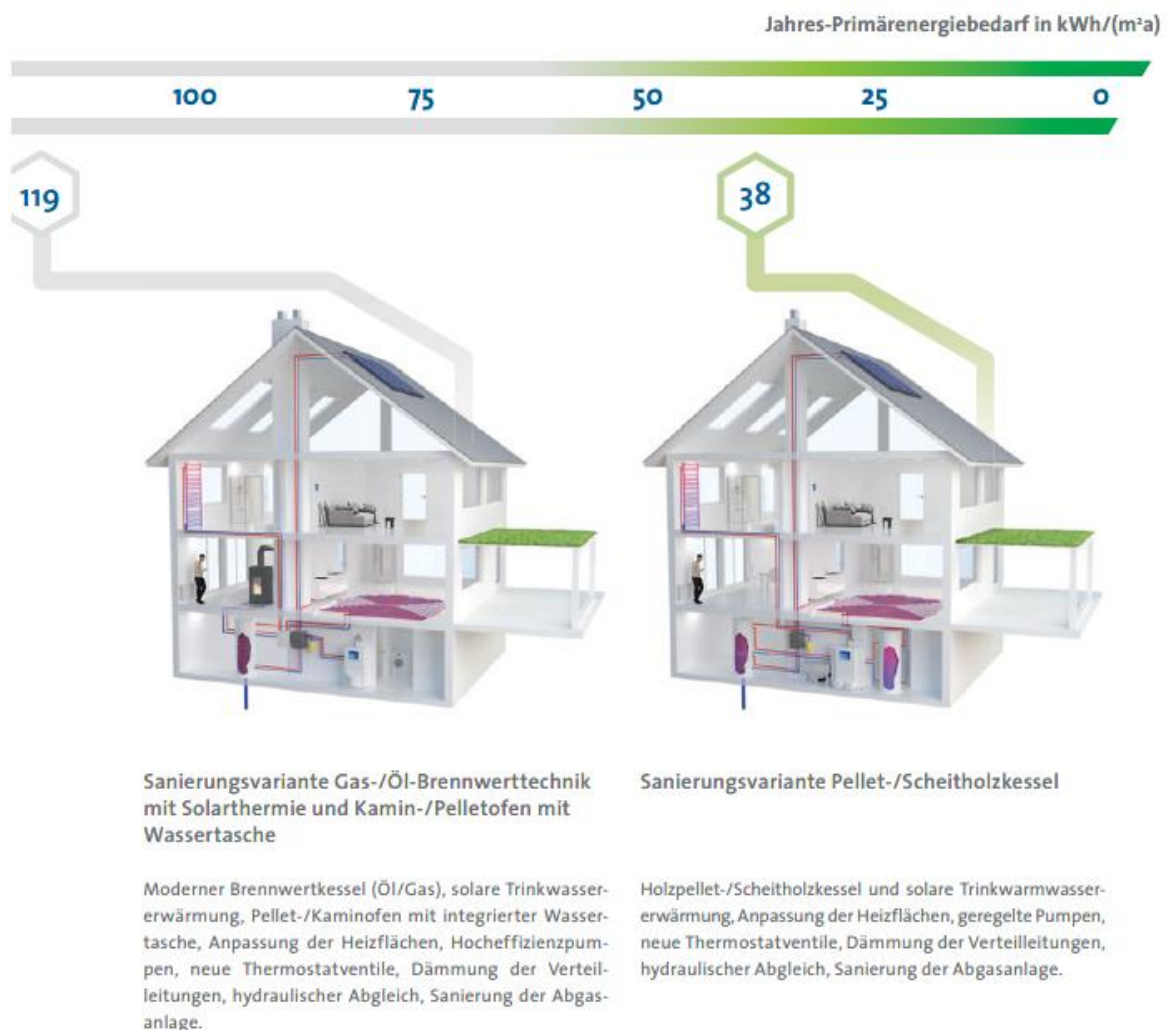
Abbildung 24 Einsparpotenziale durch Kombination effizienter Anlagentechnik und energetischer Sanierung der Gebäudehülle (BDH 2021)
