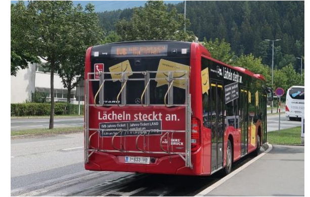
Bus der Innsbrucker Verkehrsbetriebe mit Fahrradträger (Quelle: www.bus-bild.de )
