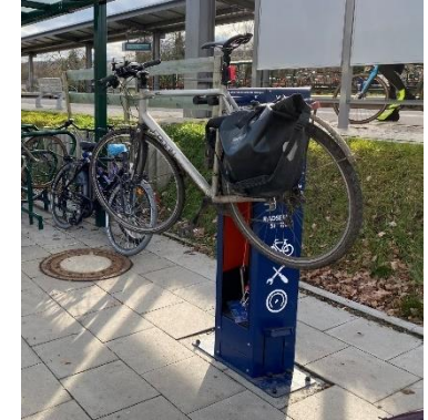
Servicestation für den Radverkehr mit Luftpumpe, Werkzeug, Montageständer
